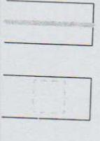
TK podzemni vod - Postojeća elektronska komunikaciona infrastruktura sa PVC i pE cijevima i bakarnim kablovima planirano TK okno - Planirano kablovsko okno NO 1,..., NO 113
