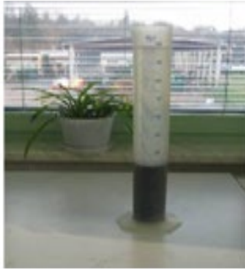
Slika. 8. Taloženje aktivnog mulja
