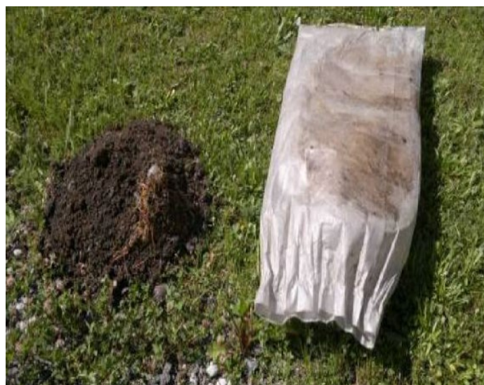
Slika 12. Dehidrirani mulj nakon obrade na modulu sa filter vrećama
