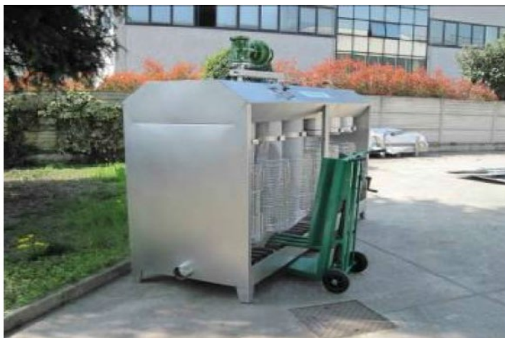
Slika 13. Sistem za obradu mulja pomoću filter vreća
