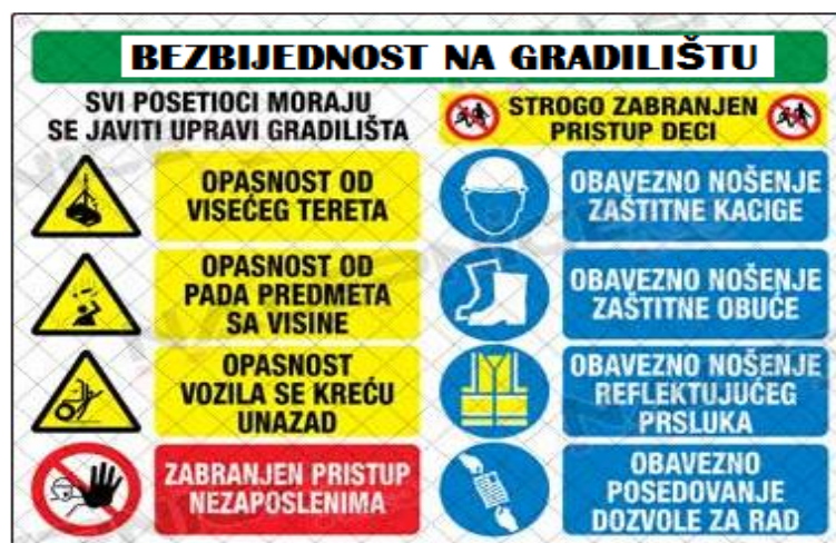
Slika 10. Znaci i upozorenja koji se moraju postaviti na ulazu u gradilište
